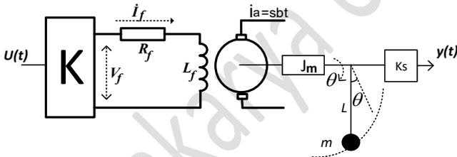
Şekilde verilen kontrol sisteminde motor miline  $L$  uzunluğunda esnek olmayan bir bağlantı ile sabitlenmiş kütle,  $\theta$  açısı ile sağa-sola döndürülmektedir. Sarkaç sisteminin motorda oluşturduğu yük momenti doğrusallaştırılmıştır  $T = mgL\theta$  ve konumu ölçme düzeneği  $Ks = 1 \frac{\text{volt}}{\text{rad}}$  olarak verilmiştir. ( $B=0$ ,  $Jm$  motor ataleti ve  $mgL=1$ )
