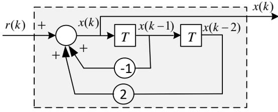
Şekilde ayrık-zaman ikinci dereceden bir sisteme ait fark denklemi için akış diyagramı verilmiştir.
